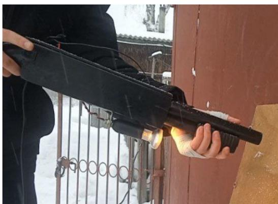
Рисунок 3. Выстрел в упор в фанеру 5мм.
